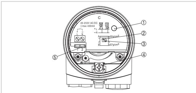
Отсек электроники и подключения (однокамерный корпус)
